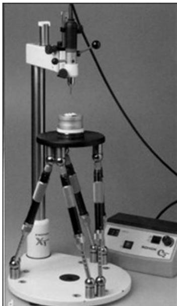
*Figura 1a: apparato di posizionamento Schick*
